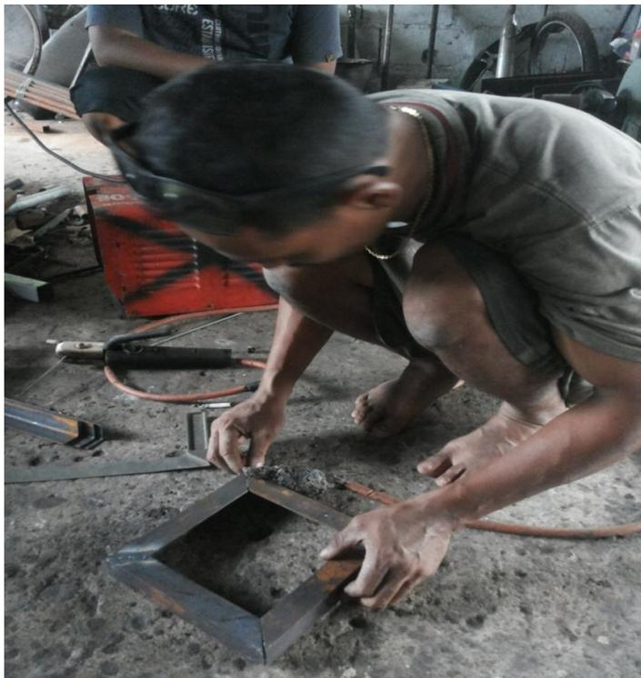
Foto Saat Pembuatan Rangka Kompor Di Bengkel Las
